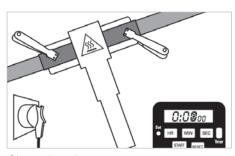
Clamp heating press Pressing time: **3 min**
